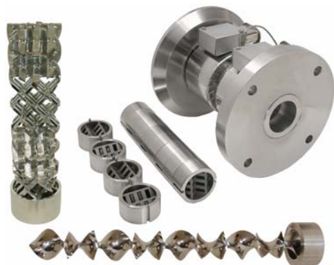
Figura #1: Mezclador StaMixCo SMB para Extrusión con Carcaza Bridada, Bandas de Calentamiento y Termocople con tres (3) tipos de diseño de elementos mezcladores
